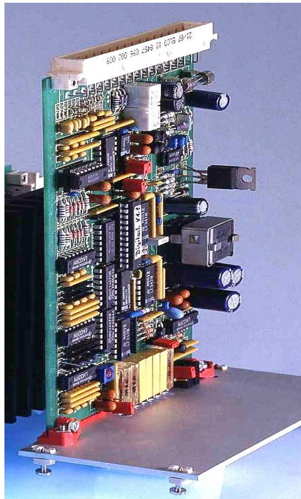
Der **Transistor-Servo-Verstärker TFM-424** arbeitet mit Gleichstrom im 4-Quadranten-Schaltbetrieb. Besonders hervorzuheben ist die **ausserordentliche Kompaktheit** (Leistung zu Volumen), sowie der **Wirkungsgrad** und die **Servicefreundlichkeit**.
