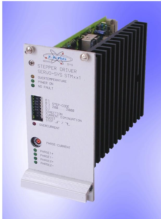
Der Schrittmotor - Servo **STM** wurde speziell für 2-Phasen Schrittmotoren entwickelt. Am Regler sind Voll- und Halb- Schritte, sowie microstep's von 400 bis 2000 Schritte einstellbar. Die Endstufe ist für einen Phasenstrom von 6 Ampere ausgelegt.
